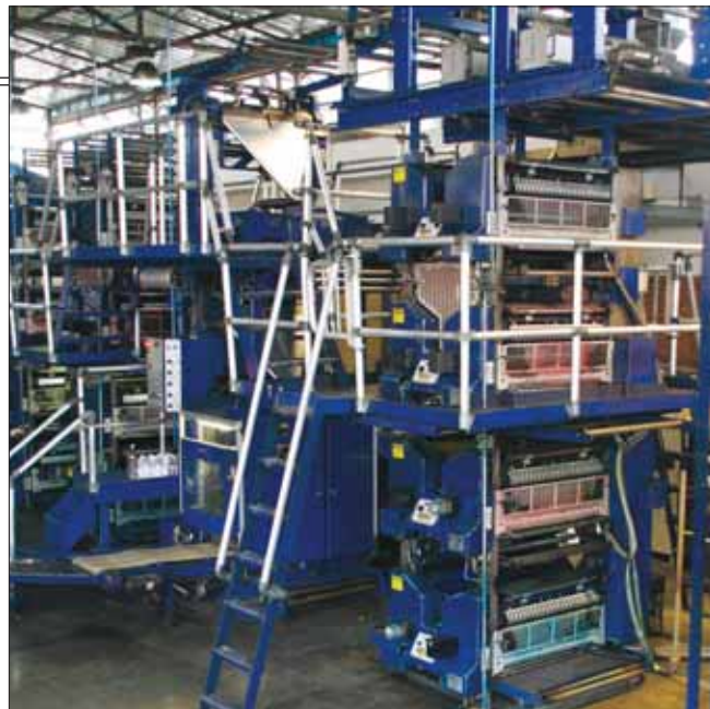
Prime UV ha equipado más de ochenta rotativas para periódicos con unidades de procesamiento y secado UV, permitiendo la producción de impresos reservados antes a las rotativas comerciales. En la foto la instalación en Diarios do Para Ltd. de Belem, Brasil.
